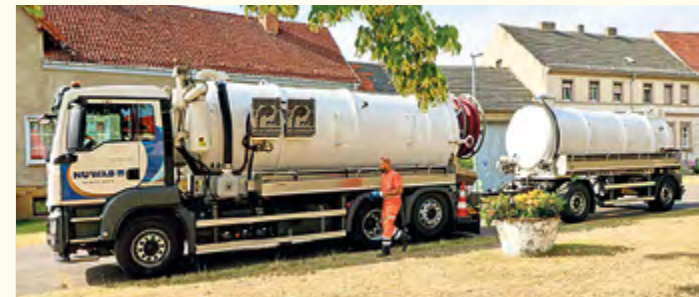
14 Kubikmeter passen vorn rein, der Anhänger kann nochmal zwölf Kubikmeter Abwasser aufnehmen.
