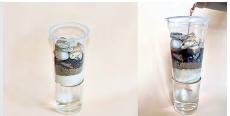
Plastikbecher befüllen, Schmutzwasser drüber gießen, Klärprozess beobachten.
