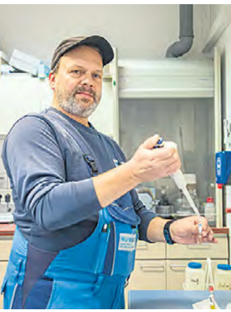
Mario Wylezol probt mithilfe des Küvetten-Tests den Chemischen Sauerstoffbedarf (CBS): Er liegt bei 26,8 mg/l – unter dem erlaubten Grenzwert von 90 mg/l.
